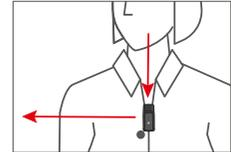
„**Surround**“ – Wenn das SurfLink externe Mikrofon 2 horizontal platziert wird (auf seinem Clip), empfängt es Schall aus allen Richtungen. Diese Einstellung ist nützlich, um mehreren Sprechern in der Nähe in einer ruhigen Umgebung zuzuhören.
