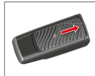
*Ausschalten* – Zum Beenden des Audio Streaming bewegen Sie den Schieber vom Micro-USB-Ende weg, bis die leuchtend farbige Oberfläche sichtbar ist. Die LED leuchtet für 2 Sekunden rot als Bestätigung, dass das Gerät aus ist.
