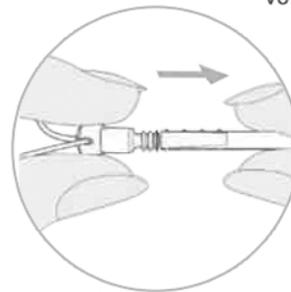
Vor dem Einsetzen des neuen Filters den Lautsprecher mit einem Reinigungstuch säubern.
