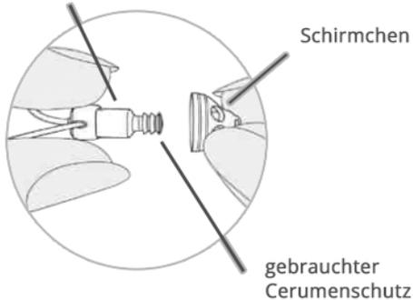
Das Stäbchen mit dem Ausziehhaken in den im Lautsprecher befindlichen Cerumenfilter stecken.
