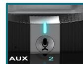
Mikrofon-Taste am Kopfhörer, um den TV-Ton abzuschalten und Umgebungsgeräusche zu hören
