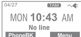
Wenn Sie die Funktionstaste **Menü** drücken, wird das Hauptmenü angezeigt. Benutzen Sie **▲** oder **▼** für das Durchsuchen des Menüs, bis Sie die gewünschte Option gefunden haben. Drücken Sie die Funktionstaste **AUSWAHL**, um die Option zu bestätigen.
