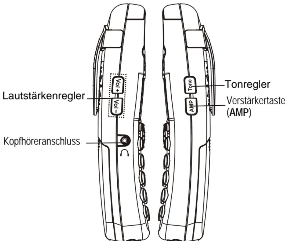
**AMP:** Zusätzlich Lautverstärkung für das Mobilteil von bis zu 15 dB
