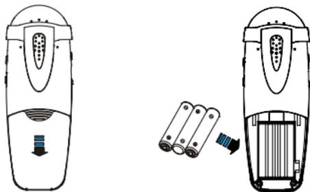
3. Zum Schließen der Batteriefachabdeckung die Abdeckung so weit nach oben schieben, bis sie einrastet.
