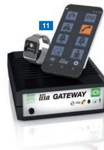
**11** Der lisa Gateway stellt die Verbindung zwischen der lisa Funk-Signalanlage und einem Router her. Damit sind lisa-Signale auch in mobilen Netzwerken verfügbar und können per Smartphone oder Smartwatch (Apple und Android) empfangen werden – im Prinzip überall auf der Welt. Die kostenlose lisa-App für Smartphones ist in den jeweiligen App-Stores verfügbar.
